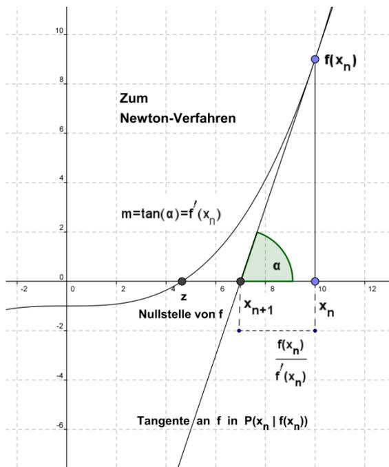
In dem nebenstehenden Bild können Sie erkennen, dass ausgehend von  $x_n$  der folgende Iterationswert  $x_{n+1}$  eine bessere Näherung an die Nullstelle liefert, d.h.  $|x_{n+1} - z| < |x_n - z|$ .
